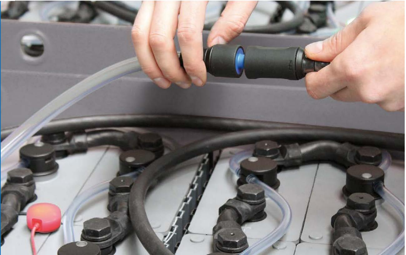
L'électrolyte, à base d'acide sulfurique et d'eau, est une des substances essentielles au fonctionnement des batteries de traction plomb-acide. Lors de la recharge, l'eau est transformée par électrolyse en hydrogène et en oxygène. Pour reconstituer l'électrolyte liquide, cette consommation d'eau doit être compensée avec de l'eau déminéralisée qui doit répondre à des exigences de pureté que garantissent l'ensemble des déminéralisateurs de notre gamme AQUApoint.
